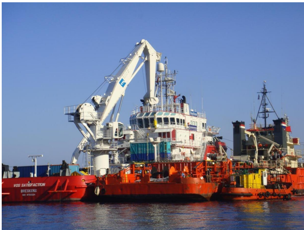
Εικ. 6 Τελική φάση της επιχείρησης απάντλησης. Μετάγγιση από το Vos Satisfaction 155 m 3 πετρελαιοειδών καταλοίπων αναμειγμένων με θαλασσινό νερό προς τις δεξαμενές καταλοίπων του ΑΙΓΙΣ
